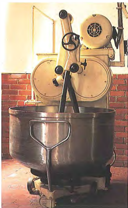
Amassadora eléctrica. Sala dos fornos da Manutenção Mil tar.
