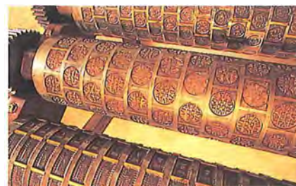
Prensa para moldar bolacha por processo contínuo. Encontra-se actualmente exposta no Museu.
