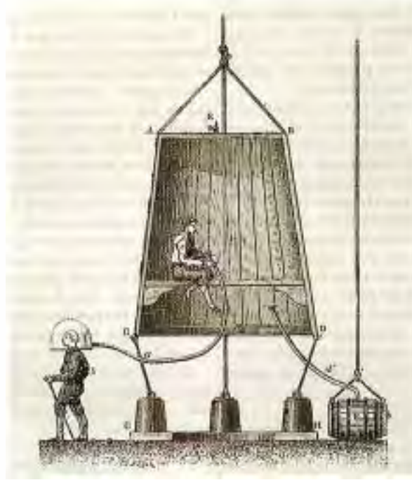
Figura 150 — O sino de Halley, in Les Merveilles de la Science , 1870.
