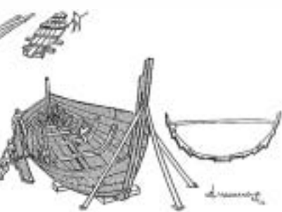
Figura 99 — Construção do tipo «primeiro o casco, depois a ossada». Técnico de construção usado sobretudo nos países nórdicos, no qual as tábuas do casco eram pregadas primeiro, umas sobre as outras, justapostas como as telhas de um telhado, e só depois se consolidava esta estrutura com pregadura de reforço interno — o covername .
