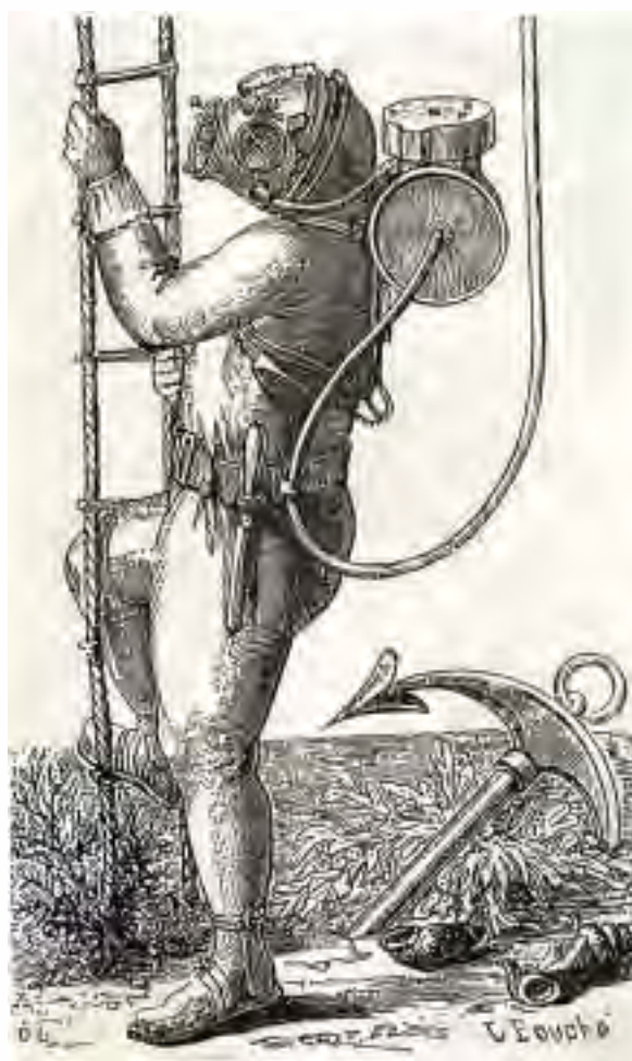
Figura 152 – O escafandro de Rouquayrol e Denayrouse, in Les Merveilles de la Science , 1870.
